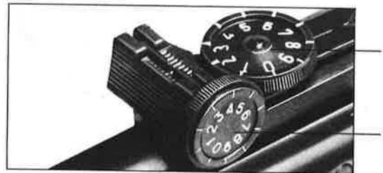
Der starke und empfindliche Mechanismus erlaubt eine 0,1 mm Höhen- und Seitenverstellung (es entspricht: ein Feld von max. 1 mm auf 10 m). Ein Mikrovisier von noch höherer Leistung ist als Zubehör erhältlich.
